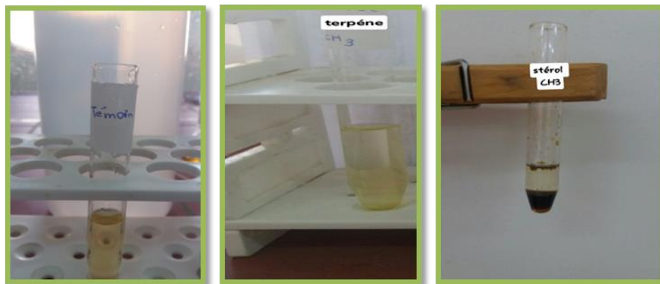
Figure(33): Révélation de terpène et stérol non saturé pour l'extract3 (CH3) par macération
