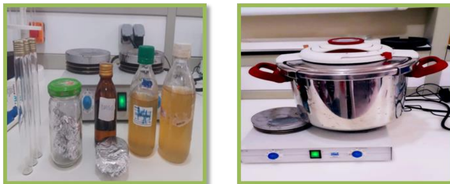
Figure (24): Stérilisation des matériels
