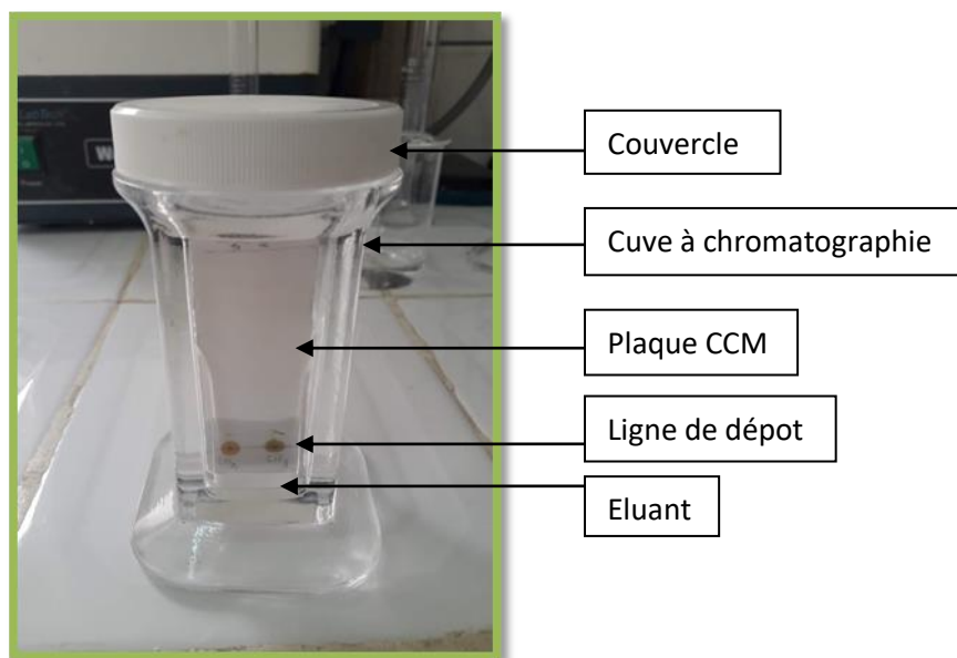
Figure (20): Les composants d'une cuve chromatographique
