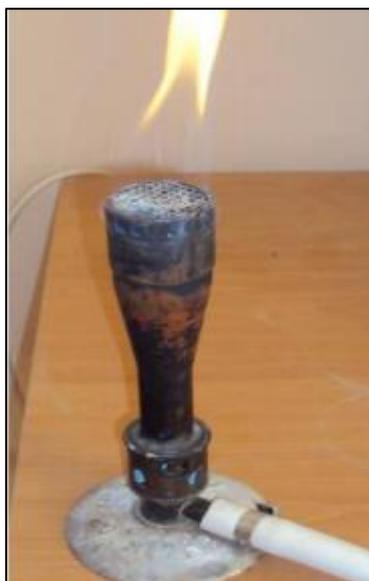
**Figure II.3 :** Bec benzène utilisé dans la synthèse des verres.
