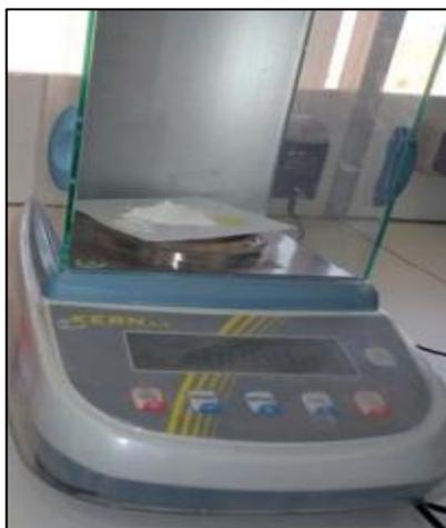
**Figure II.2** : Balance de précision de type Kern .
