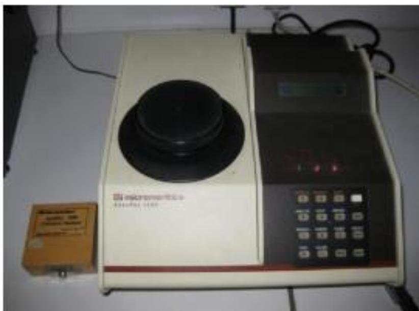
**Figure II.7:** Pycnomètre à hélium Micromeritics, AccuPyc 1330 .
