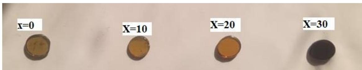
**Figure III.2** : Photographie des échantillons du système SLM :  $(90-x)\text{Sb}_2\text{O}_3-10\text{Li}_2\text{O}-x\text{MoO}_3$ .
