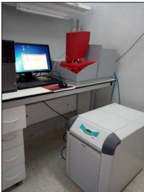
**Figure II.8** : Calorimétrie Différentielle à Balayage DSC SETARAM evosys.
