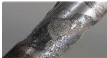
Figure (I.5) :Corrosion inter granulaire dans un tube d'aluminium
