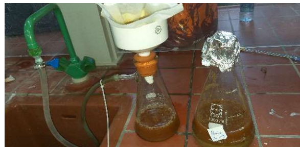
Photo 11 : le montage de filtration sous vide.
