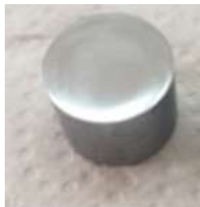
Photo 13 l'échantillon de l'acier X70
