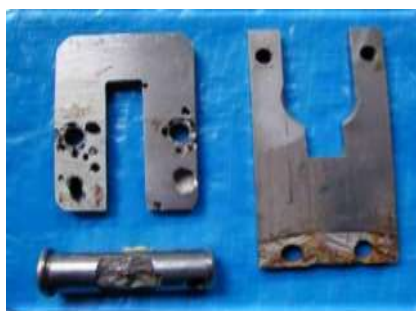
Figure (I.8): Pièces d'acier "inoxydable" corrodées par un séjour en eau de mer
