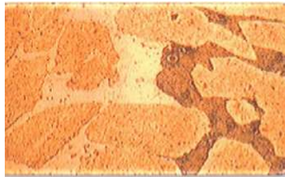
Figure (I.4) : Coupe métallographique montrant une corrosion sélective d'un laiton
