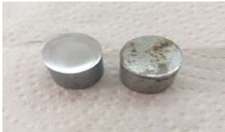
Photo 22 : l'acier X70 corrosion par piquer.
