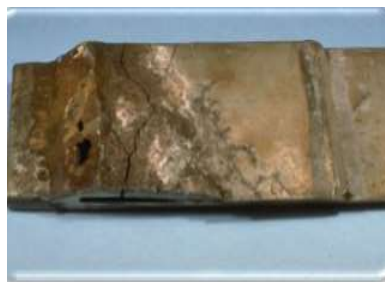
Figure (I.7) : Corrosion sous contrainte d'un assemblage en acier allié soudé (contraintes liées au soudage)
