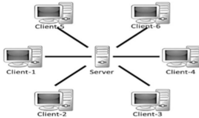
FIGURE 2.1 – *Un système centralisé* [37]
