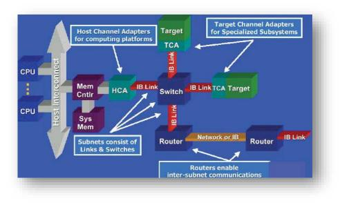
**Figure II.7: Infiniband components**
