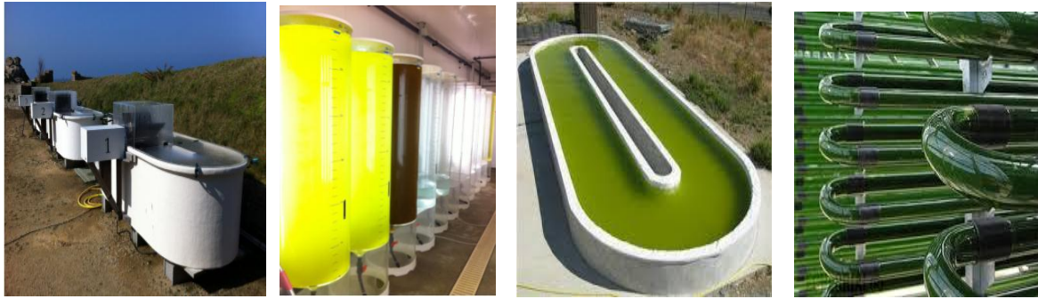
Figure 07 : Bassins de production phytoplanktonique en extérieur avec une capacité de 2m3, Salles de production phytoplanktonique des grand volumes (300L) sur le site d'Ifremer Argenton (29).
