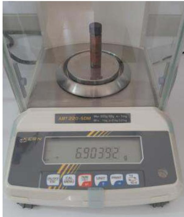
**Figure 10.** Pesage des huiles essentielles obtenues par hydrodistillation.
