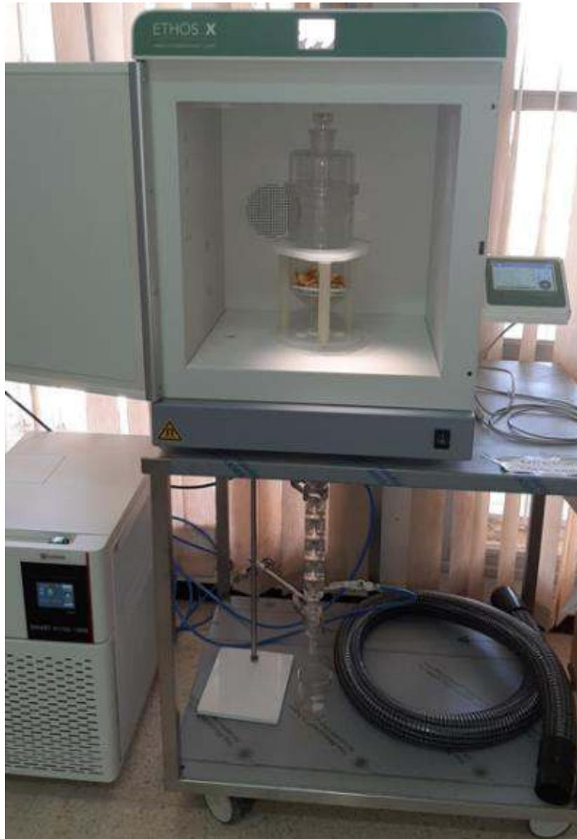
**Figure 12.** Extraction par hydrodiffusion assistée par Micro-ondes et Gravité (MHG).
