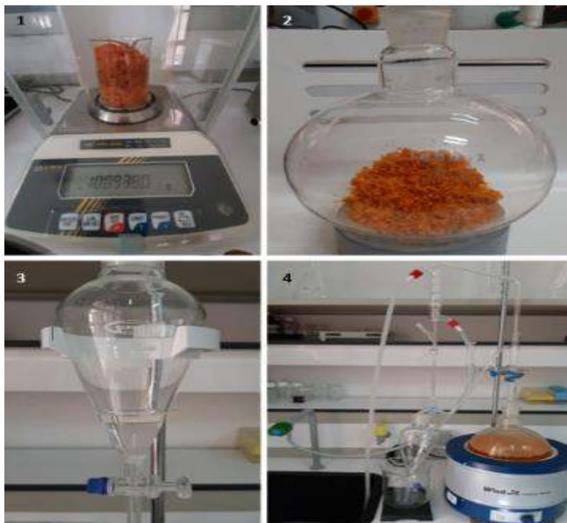
**Figure 9.** Processus d'extraction des huiles essentielles du Bigaradier par hydrodistillation à l'aide d'un appareil de type Clevenger. **1,** Pesage du zeste de Bigarade; **2,** Le mettre dans le ballon; **3,** Montage d'HD Clevenger ; **4,** décantation de l'HE.
