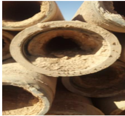
Figure 09: Conséquence de l'entartrage (Photo originale)
