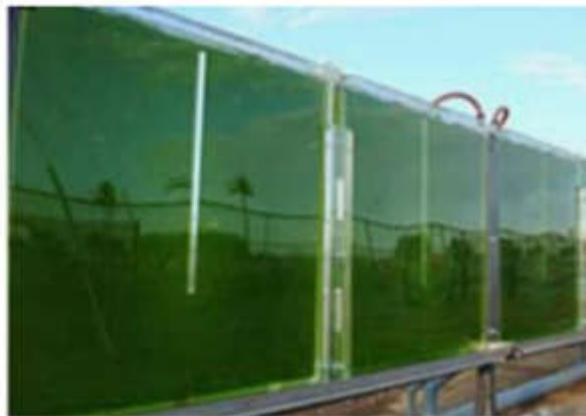
**Figure 16** : Photo bioréacteur plan (Bitog et al, 2011)
