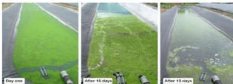
**Figure 31 :** Traitement des eaux usées par les microalgues (Algae Control Thrive water – Alternative Wastewater Treatment Solutions,)
