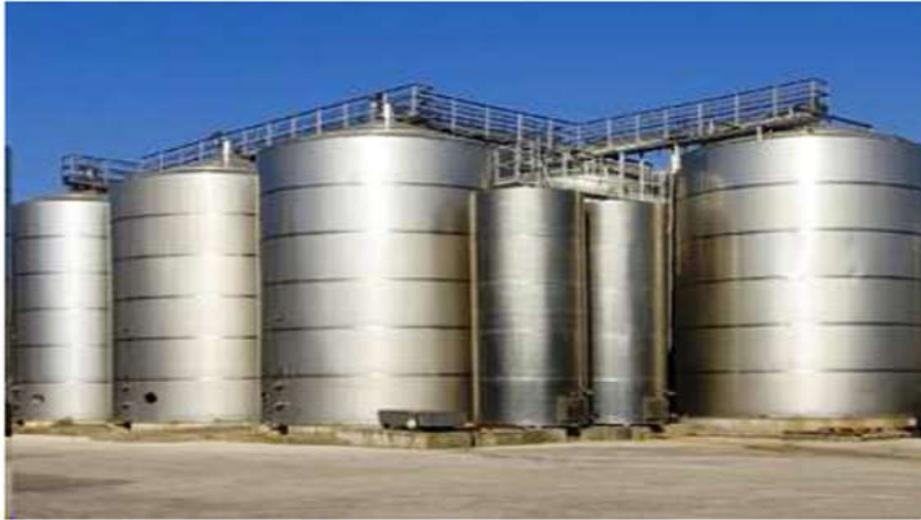
**Figure 21** : fermenteur de production d'Oméga-3 à partir de microalgues (FERMENTALG, 2013)
