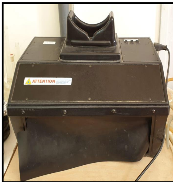
Figure 4. Chambre noire pour CCM à lampe UV.
