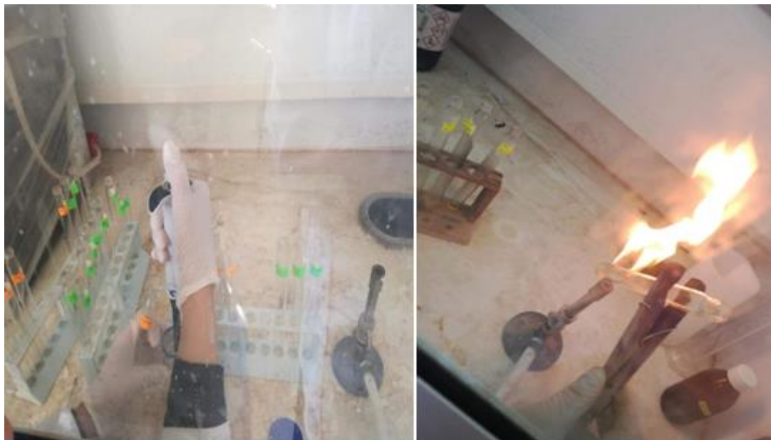
Adition de réactif de minéralisation et chauffage des tubes au bec bunsen
