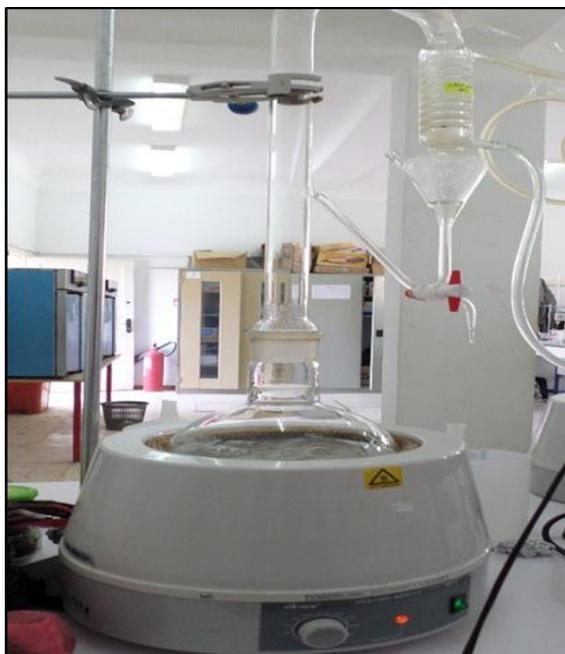
**Figure 8.** Dispositif de type Clevenger utilisé pour l'extraction des huiles essentielles.
