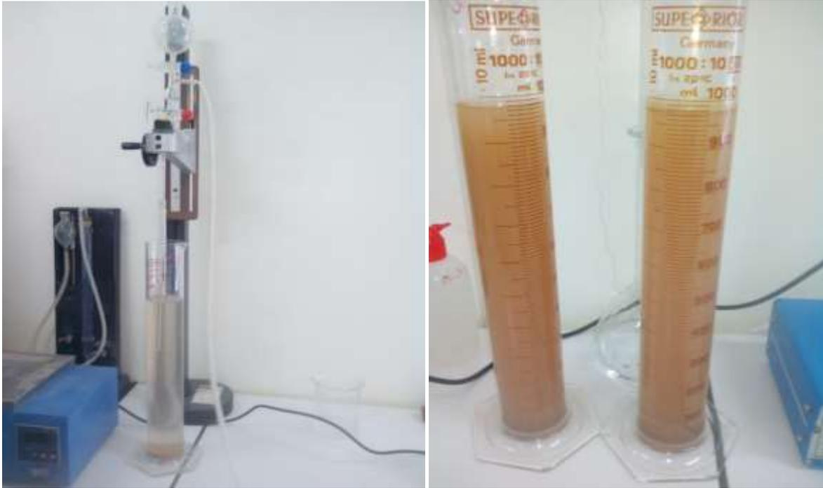
**Figure 10** .Réalisation de l'Analyse granulométrique par l'utilisation de la pipette de robinson (photo originale).
