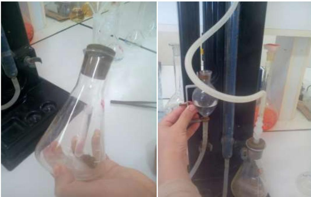
**Figure 14.** Détermination de La calcaire total par la méthode de Woodward (1961), par le calcimètre de Bernard.
