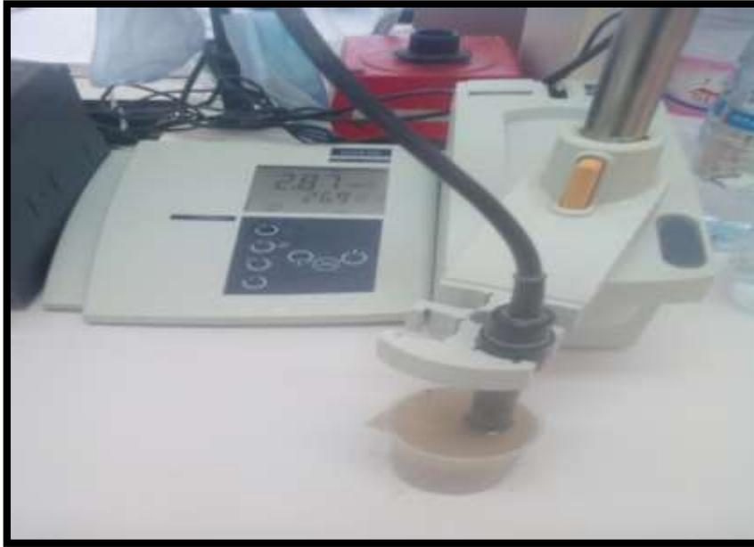
**Figure 13.**Détermination de la conductivité électrique par un conductimètre.
