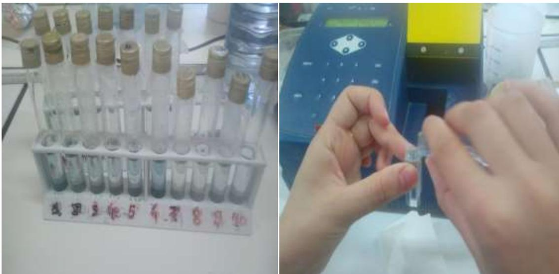
**Figure 17.** Dosage de phosphore à l'aide d'un spectrophotomètre.
