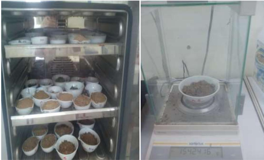
**Figure 11.**Détermination de la teneur de l'Humidité
