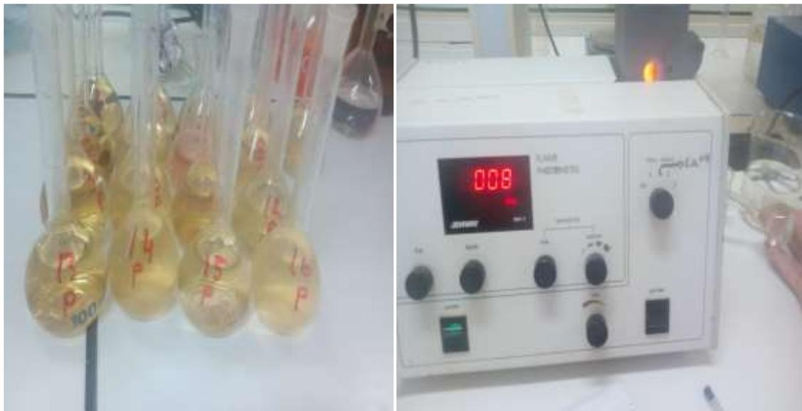
**Figure 18.** Dosage de potassium par photomètre à flamme
