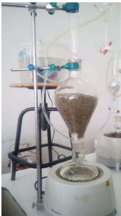
Figure2. Montage d'hydrodistillation (entraînement à la vapeur d'eau).
