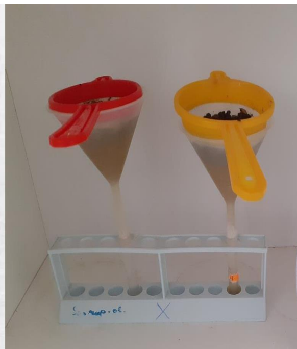
Figure 15 – Schéma du montage de Baermann
