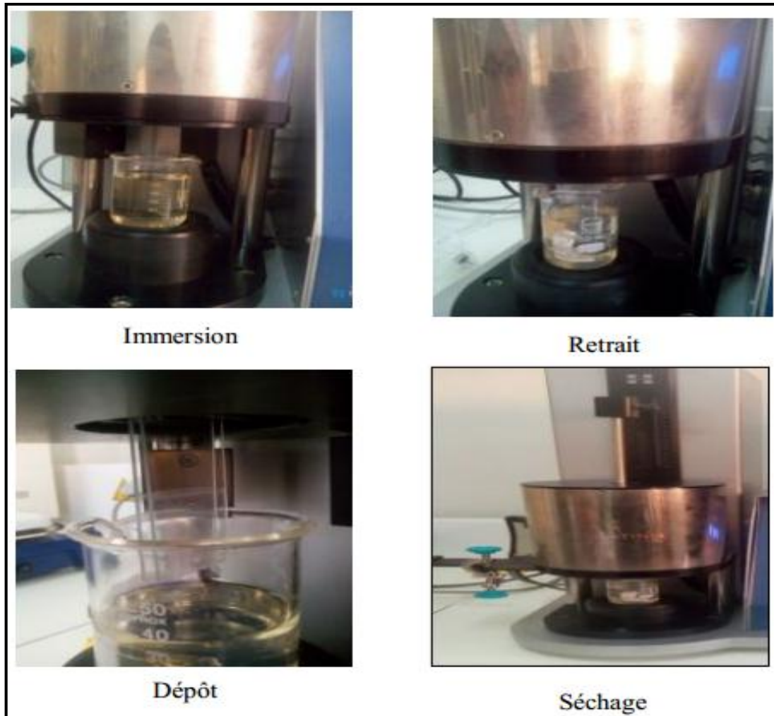
Figure II.7: Le principe du trempage – Tirage (dip-coating).
