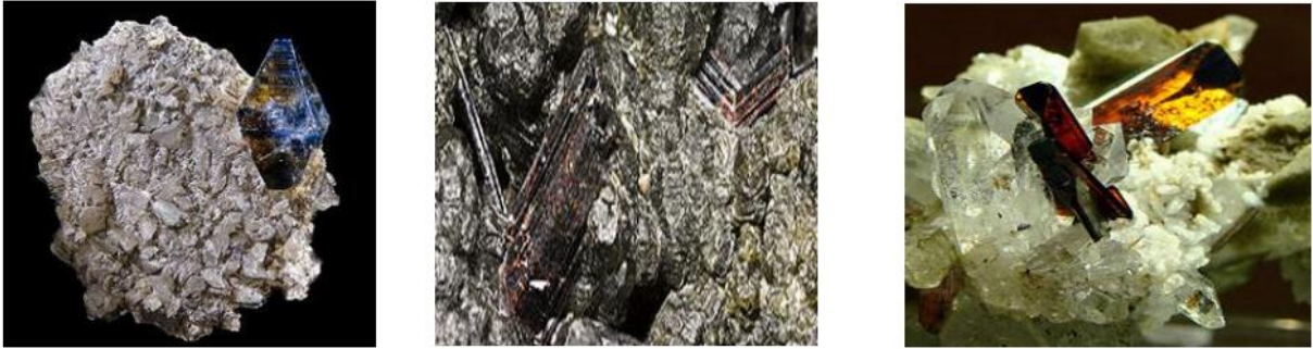
Figure I. 25: Espèces minérales formée d'oxyde de titane: (a) anatase; (b) rutile; (c) brookite [33].
