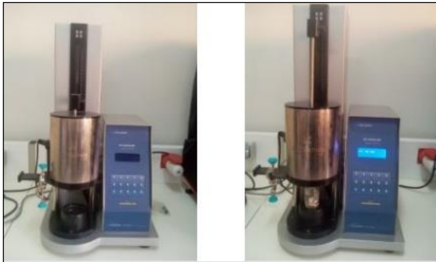
Figure II. 5 : Dispositif expérimental de dépôt dip- coating model HO-TH-02B avant et après le démarrage.
