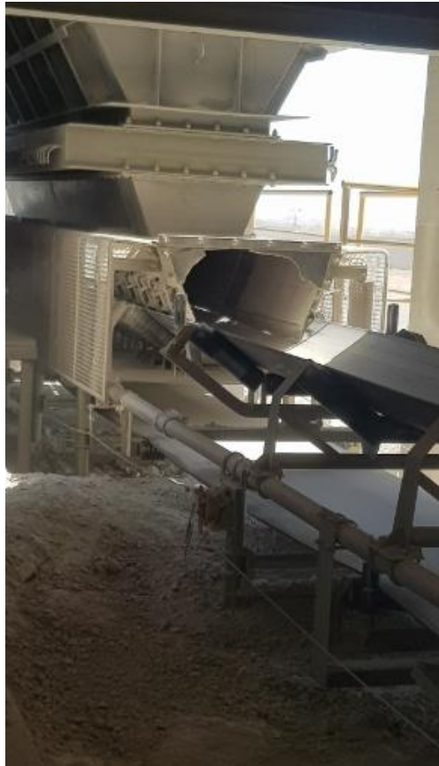
Figure III.11.La bande de la trémie (n°4)
