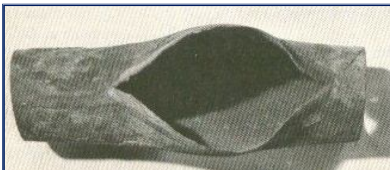
Figure II.12 : Photo pour un exemple typique d'une rupture d'un tube causée par une surchauffe.
