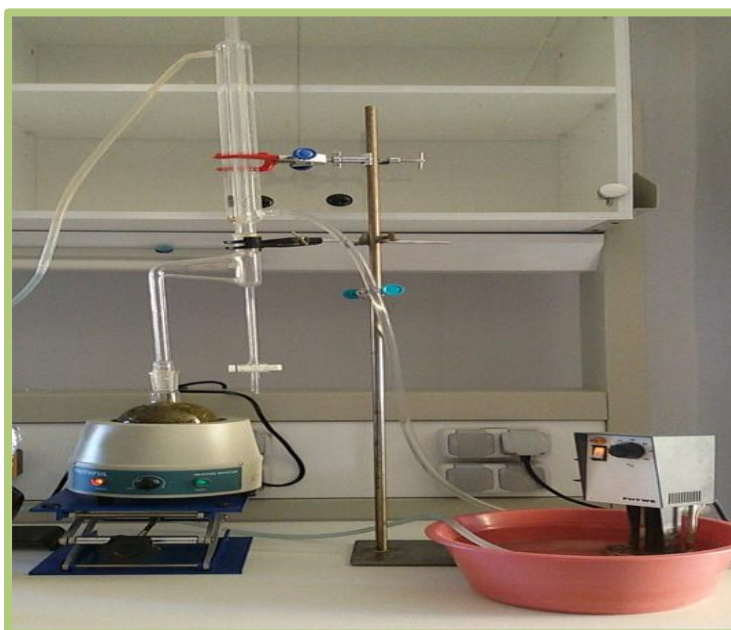
Figure III.35 : Montage de Clevenger
