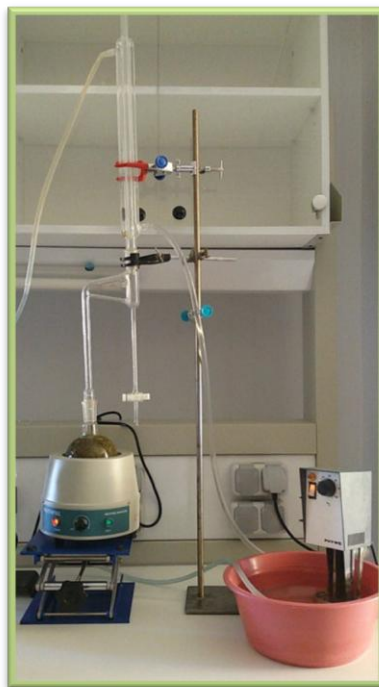
Figure II.12 : montage de clevenger
