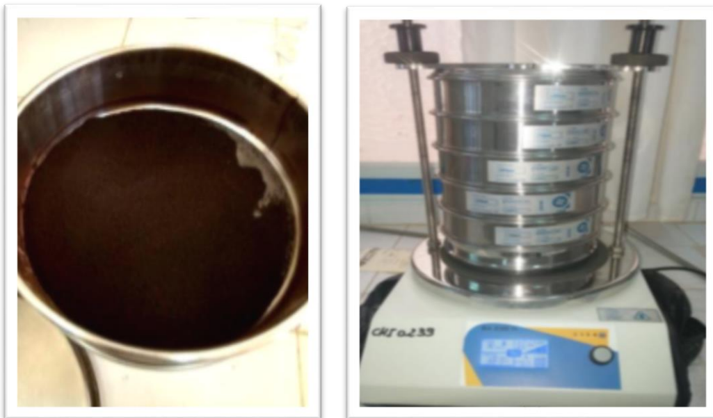
Figure II.3 : Tamisage des coques de noix
