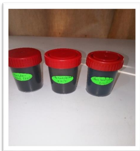
Figure II.7 : le charbon brute et charbon actif obtenues
