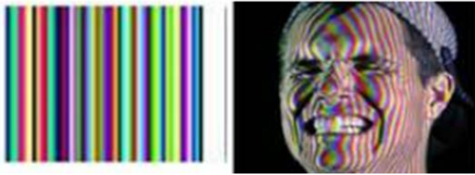
Figure 1.5 : Exemple de lumière structurée (à gauche) et sa projection sur un visage.[9]
