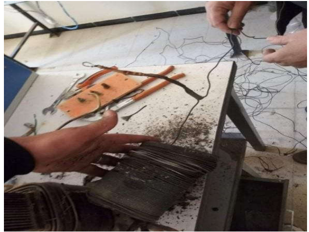
Fig.III.10. Enroulement à 280 spires récupérées de l'enroulement endommagé
