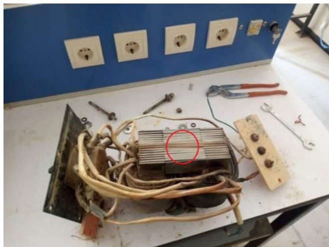
Fig.III.7. Serrage des tôles
