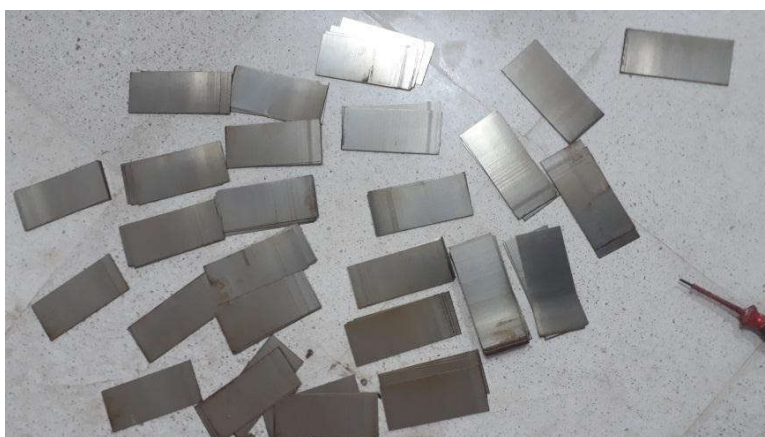
Fig.III.5. Tôles magnétiques utilisées dans la fabrication du circuit magnétique
