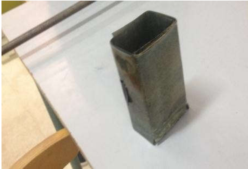
Fig.III.11. Support isolant entre enroulement et circuit magnétique
