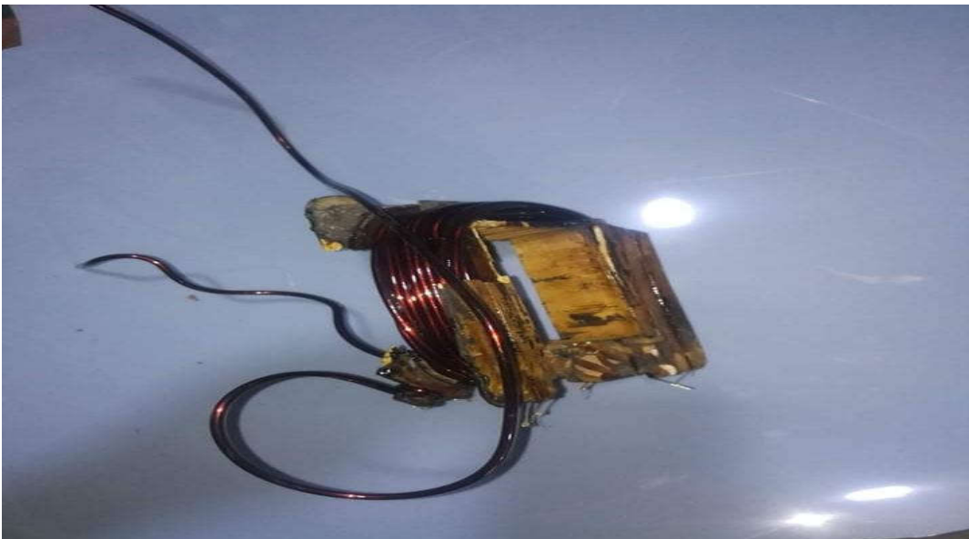
Fig.III.2b. Bobinage primaire partiellement endommagé
