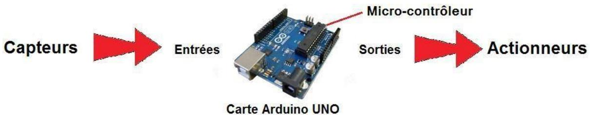
**Figure IV.27.présentation (capteurs +actionneurs) de la carte Arduino**
