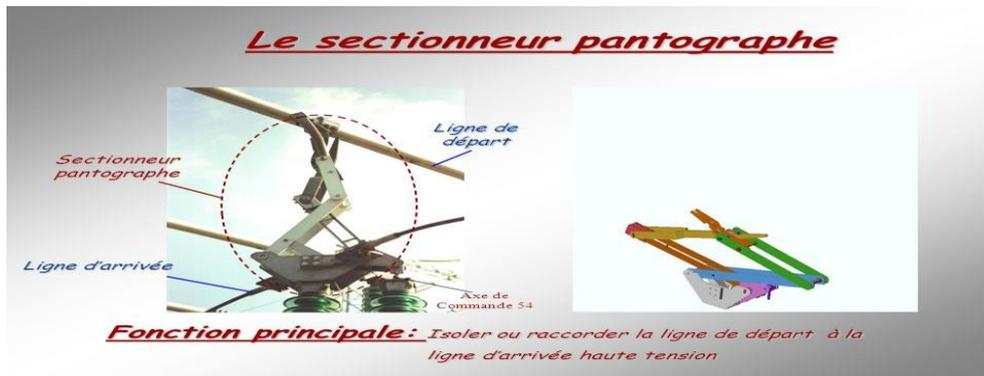
FigureII-16 Sectionneur pantographe [17]
