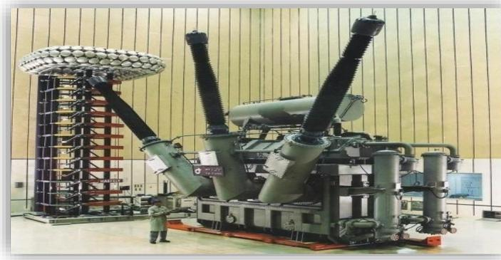
Fig. I.2. Transformateur de puissance [6]
