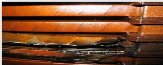
Fig. II.5. Amorçage diélectrique entre spire [14]
