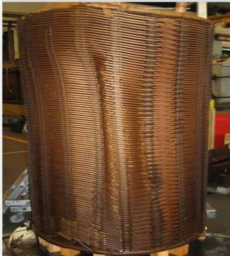
**Fig. II.8.** Déformation géométrique des enroulements [14]
