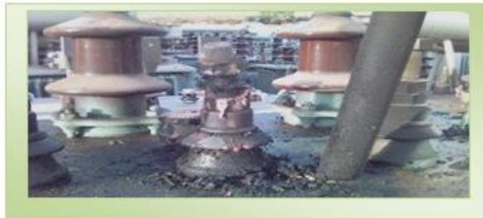
**Fig. III.3.** Défaut suite au mauvais serrage sur borne BT [17]
