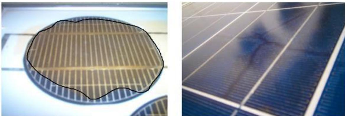
**Figure I- 20 :** Modules photovoltaïques avec des cellules décolorées [17].
