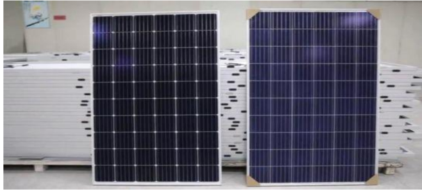
Figure 1.05 : module au silicium polycristallin
