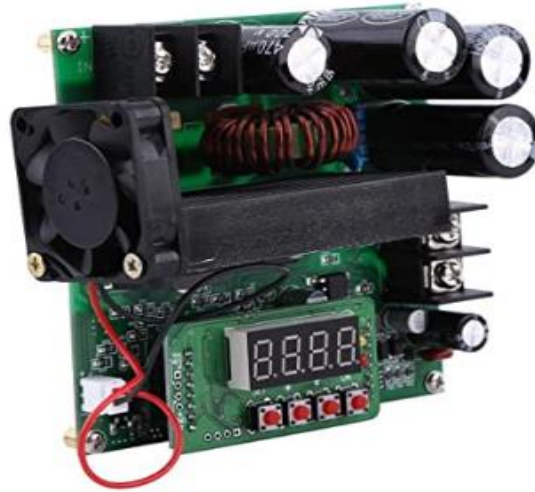
Figure (3.9) : Convertisseur DC-DC boost
