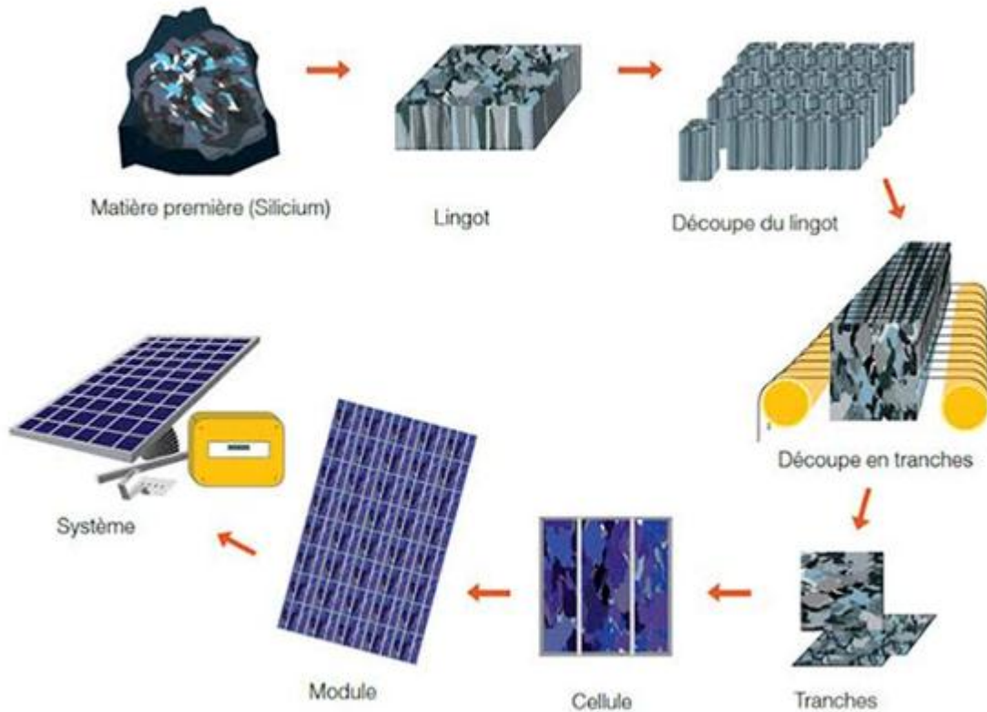
Figure II.2: Différentes étapes de production d'un système photovoltaïque.
