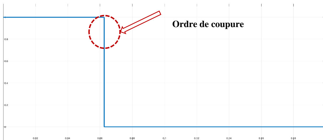
Fig III. 9 : Signal de commande du disjoncteur.
