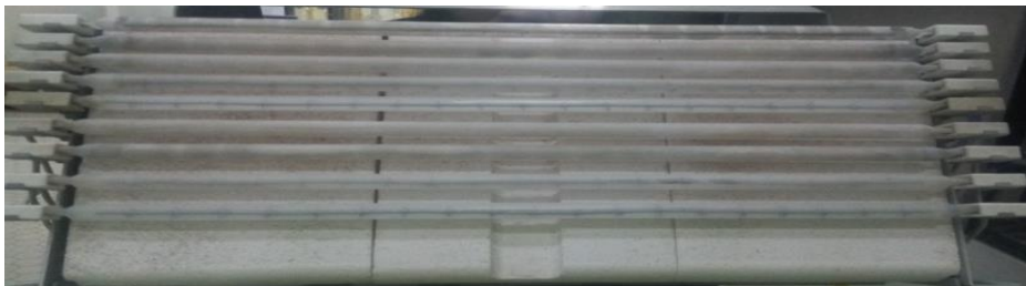
Fig.III.3.Les lampes infrarouges du four.
