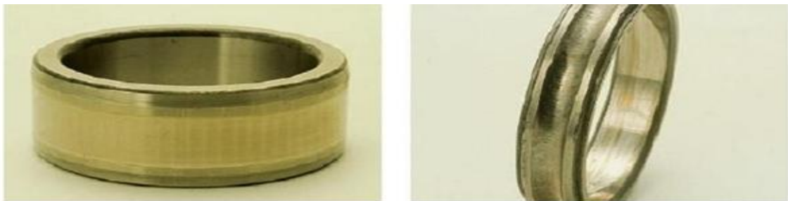
Figure I.6: corrosion sur une piste de roulement [24].
