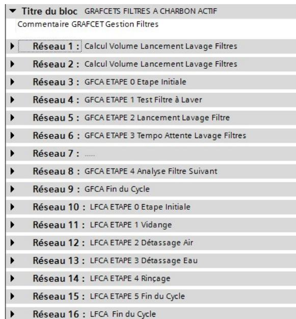
Figure 3.11 vue globale du FB210 contient les grafkets du filtres à charbon active.
