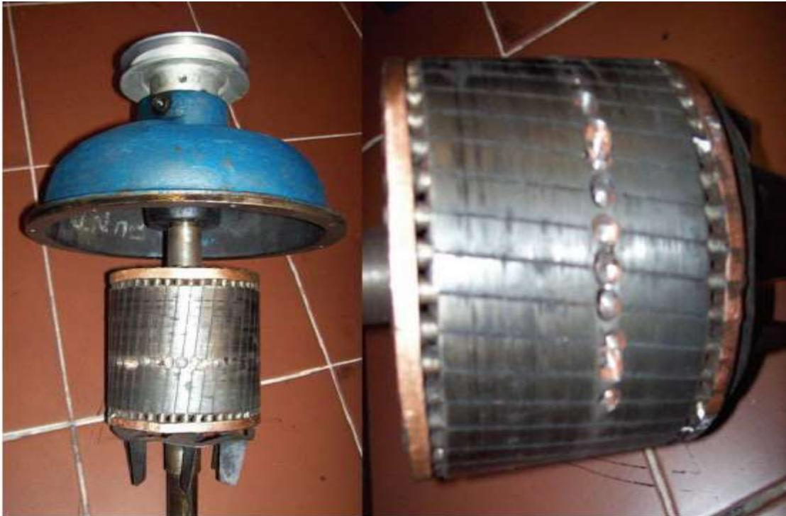
**Fig.1.9** cassure de barres au rotor
