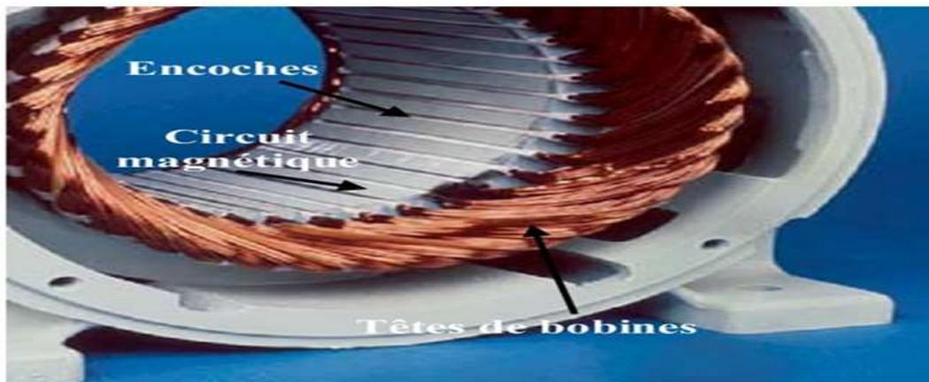
Fig.1.3 Photo d'un stator d'une machine asynchrone.
