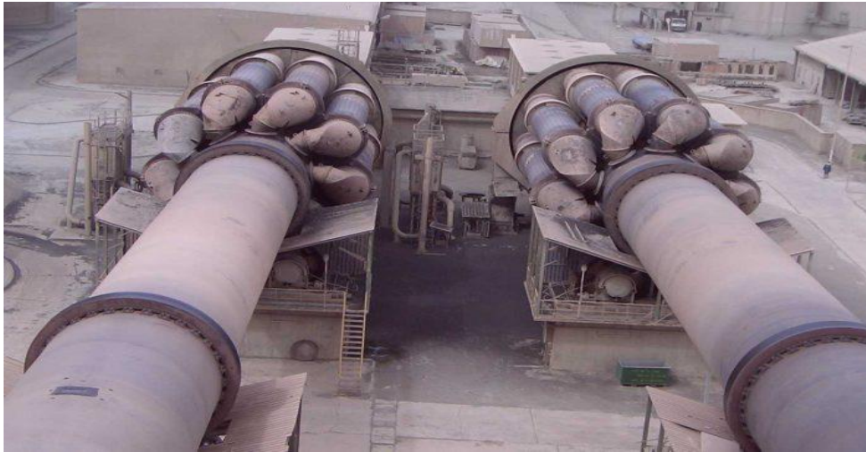
Figure I.9 : Cuisson « formation du clinker »
