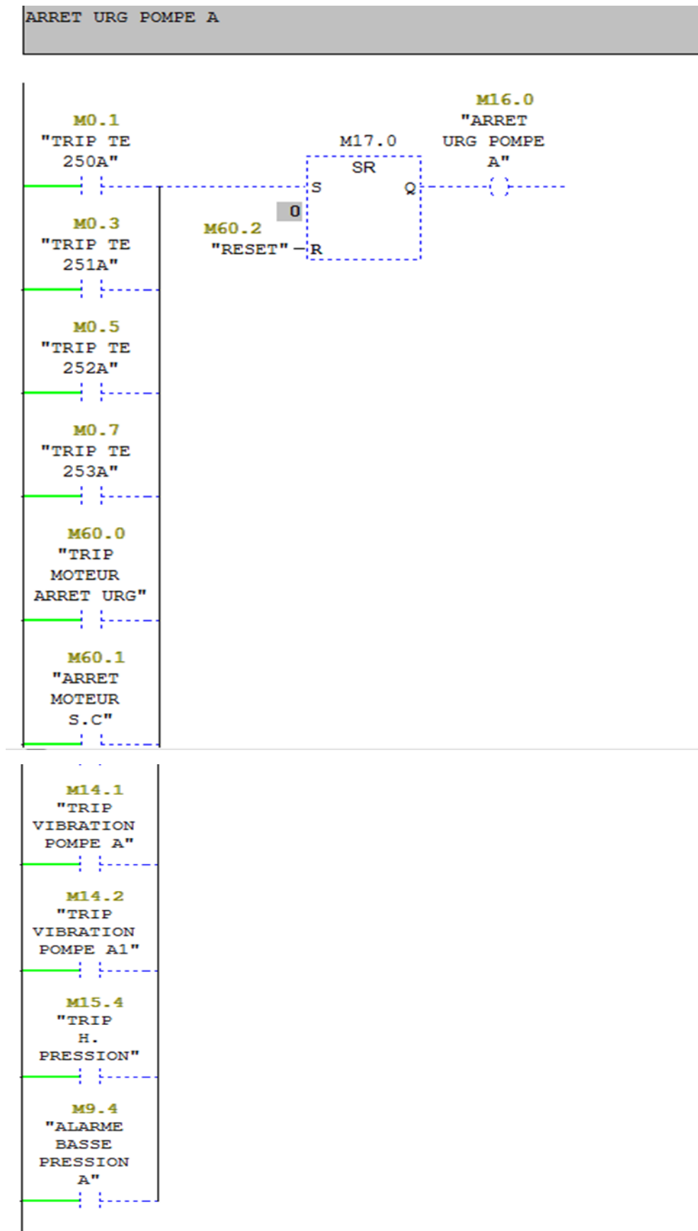
Figure IV.24. Vue simulation niveau ESD 2 avant déclenchement (step7).
