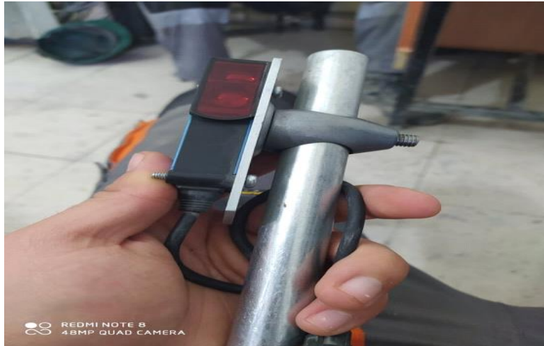
Figure I.18 : Détecteur émetteur récepteur
