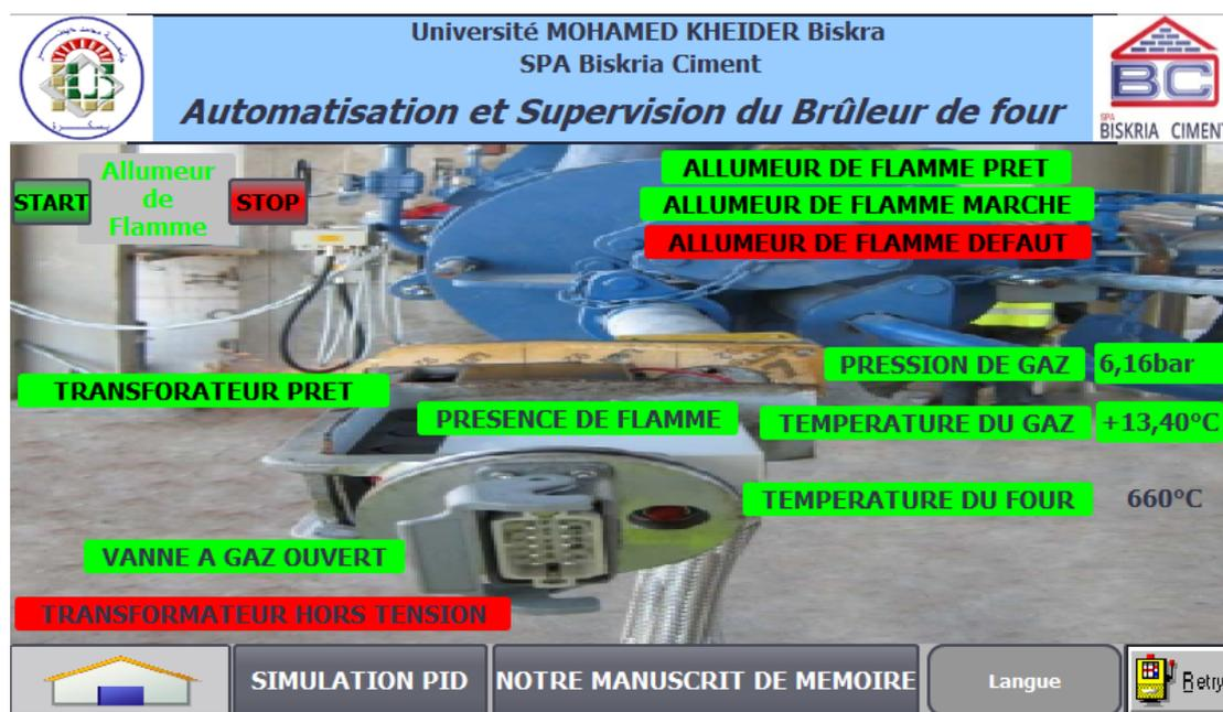
FIGURE 3.58 – La vue détaillé d’allumeur de flamme sur HMI (2).
