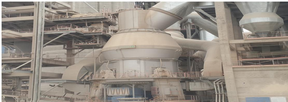
FIGURE 1.7 – Broyeur cru vertical à galets [1].
