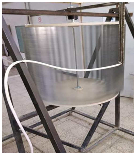
FIGURE III.21 :: Turbine éolienne à axe verticale en marche
