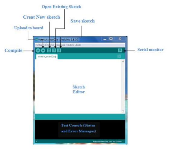
Figure II.5. Arduino IDE sketch
