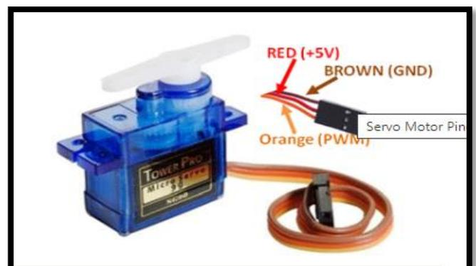
Figure II.32: brochage de servomoteur
