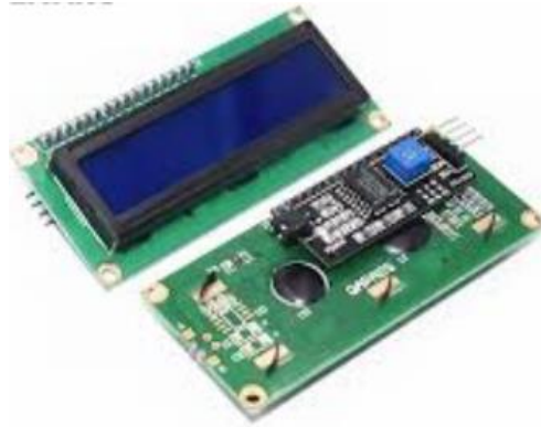
Figure III-6 : Ecran LCD avec système de connexion I2C
