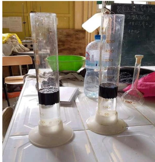
Figure IV.14 : la masse volumique absolue des agrégats plastique (PEHD).
