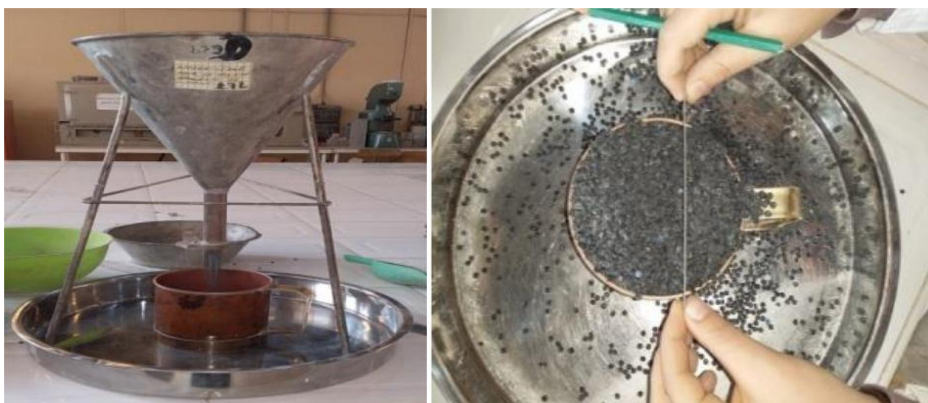
Figure IV.13 : l'essai de la masse volumique apparente des granulats PEHD
