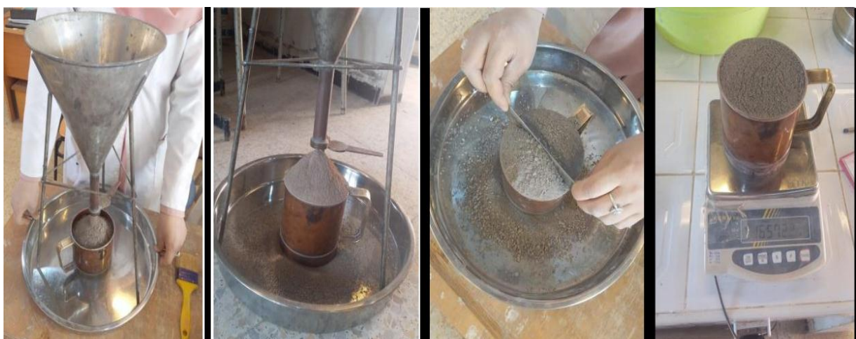
Figure IV.4: Essai de la masse volumique apparente du sable concassé
