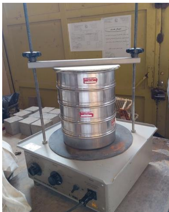
Figure IV.15: Tamis sur tamiseuse électrique.
