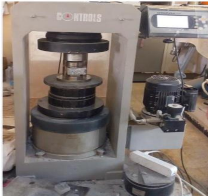
Figure V.7 : Presse pour mortier (Machine de compression)
