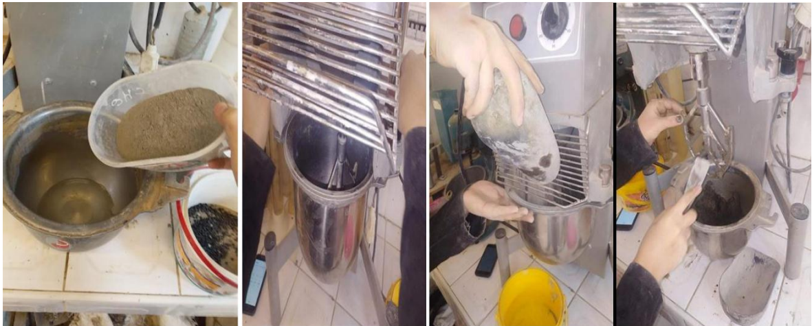
Figure IV.21 : Malaxage des composants du mortier.
