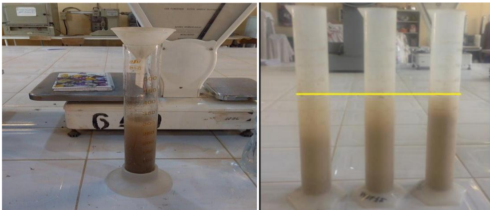
Figure IV.6 : masse volumique absolue de sable
