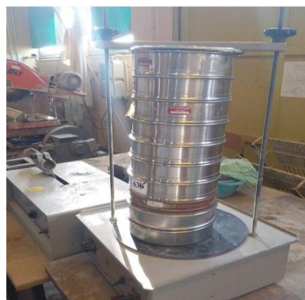
Figure IV.8 : Tamis sur la tamiseuse électrique.
