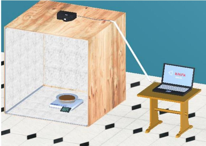
*Figure II. 13. Schéma 3D pour dispositif expérimental.*
