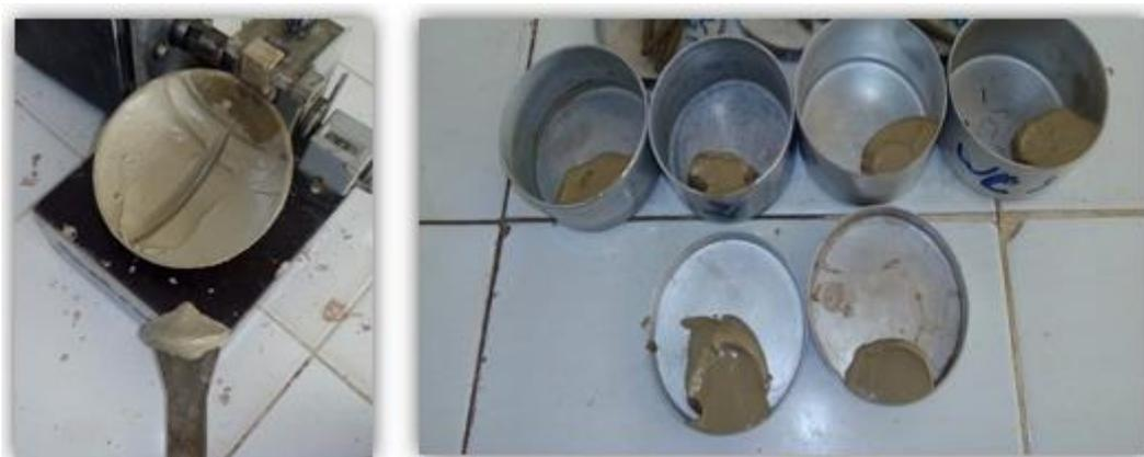
Figure II. 7. Exécution de l'essai de la limite de liquidité.
