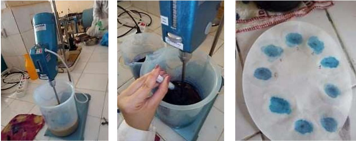
Figure II. 10. Application des taches sur papier filtre (Réalisation de l'essai au Bleu de Méthylène).
