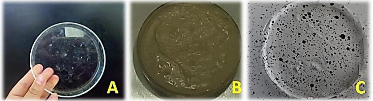
*Figure II. 18. Préparation d'échantillon pour coloration d'image, (A) coupelle vide, (B) L'échantillon est placé dans la coupelle, (C) Pulvé à surface de l'échantillon peinture blanche et points noirs par la peinture noire.*
