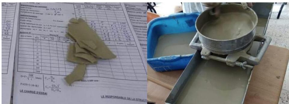
Figure II. 4. Préparation de l'échantillon pour l'essai sédimentométrique.
