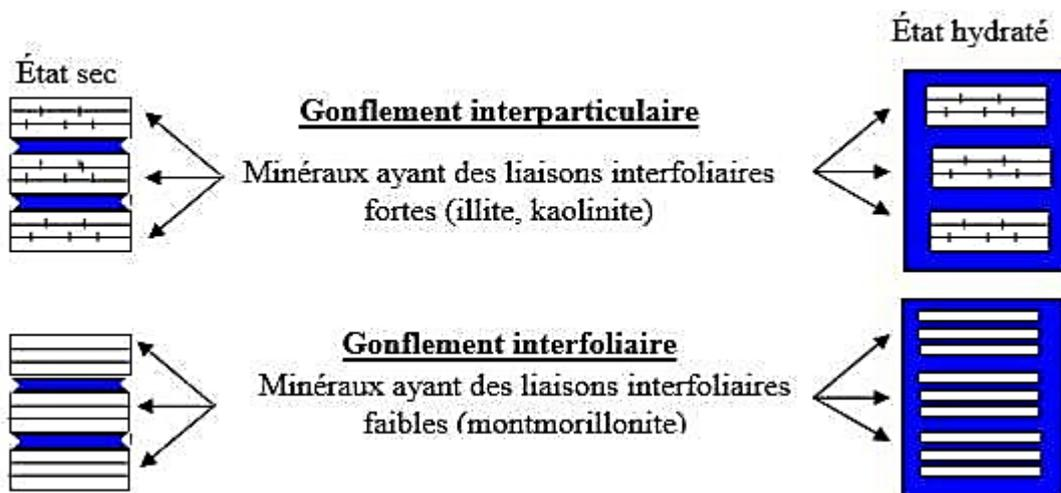
*Figure I. 14. Mécanismes de gonflement des argiles par hydratation.*
