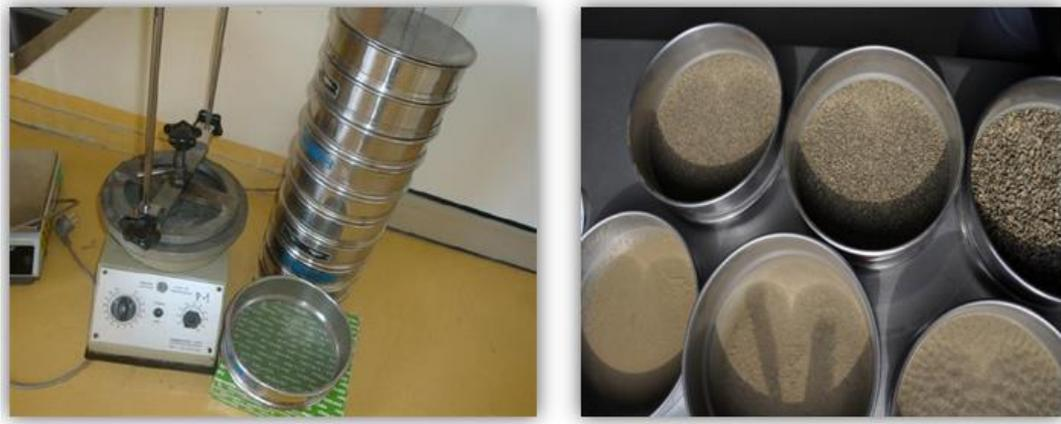
Figure II. 3. Photos montrant l'essai de tamisage.
