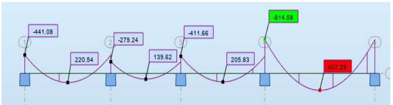
Figure VI-13: Diagramme des moments fléchissant à L'ELS en sens (x-x).
