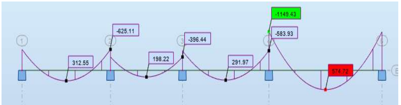
Figure VI-11: Diagramme des moments fléchissant à L'ELU en sens (x-x).
