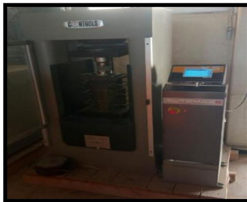
**Figure IV.16:** Essai de résistance à la compression
