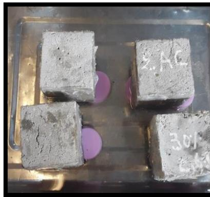
**Figure IV.13:** Essai d'absorption capillaire
