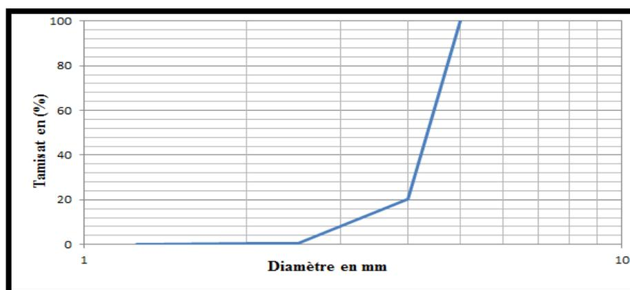
**Figure IV.5:** Analyse granulométrique de plastique
