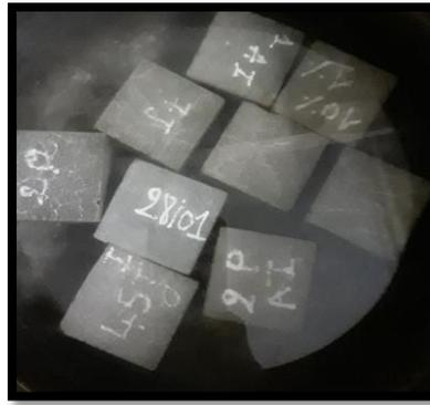
**Figure IV.12:** Essai d'absorption par immersion
