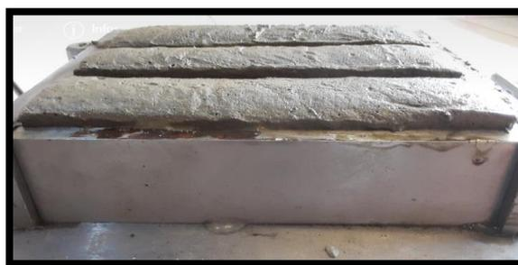
Figure IV.10: Gonflement des éprouvettes du mortier
