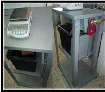
Figure IV.11: Appareil de pesée hydrostatique
