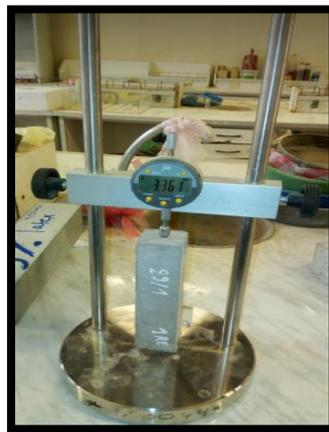
**Figure IV.14:** Appareil pour la mesure du retrait et du gonflement
