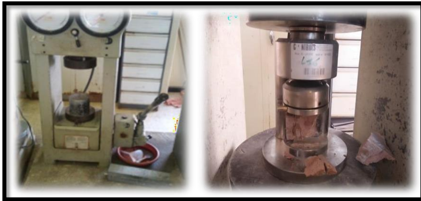
Figure IV.25 : machine d'essais à la pression avec dispositif de compression et de traction.
