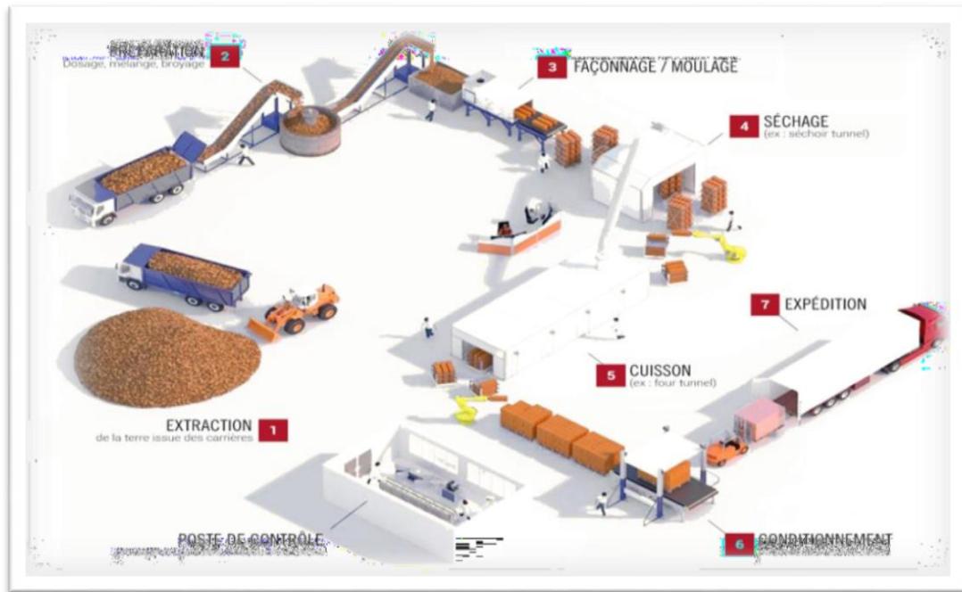
Figure III.7: Les différents processus de fabrication de brique (rouge) terre cuite.
