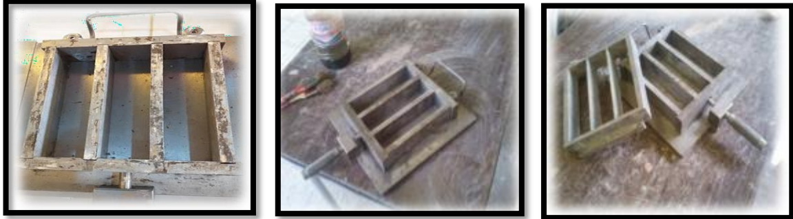
Figure IV.21 : Moules pour éprouvettes 4×4×16.
