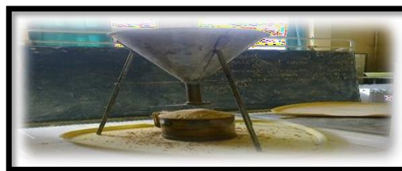
Figure IV.7 : les matériels de l'essai la masse volumique apparente .
