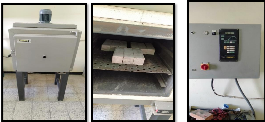
Figure V.1 : Les fours électriques et les éprouvettes utilisées.
