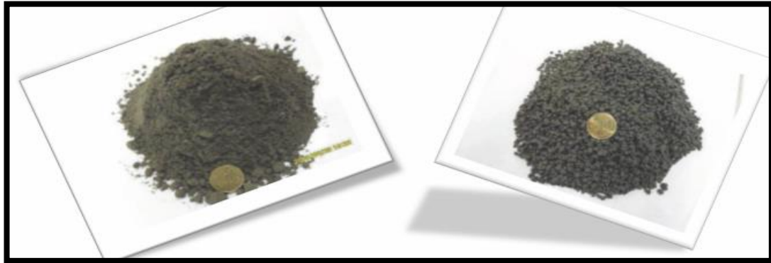
Figure I.10: Cas de mauvaise formulation (a) mélange trop sec (b) formation des grumeaux[Ladour , 2014].
