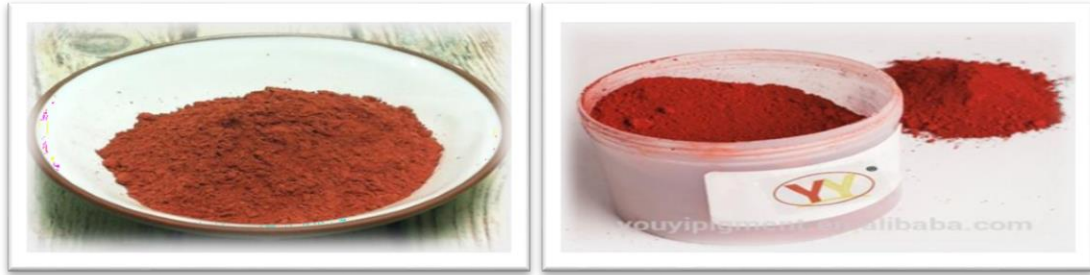
Figure III.10 : Exemple de valorisation de déchets de brique rouge comme un poudre . [Marc Mélon ,2017].
