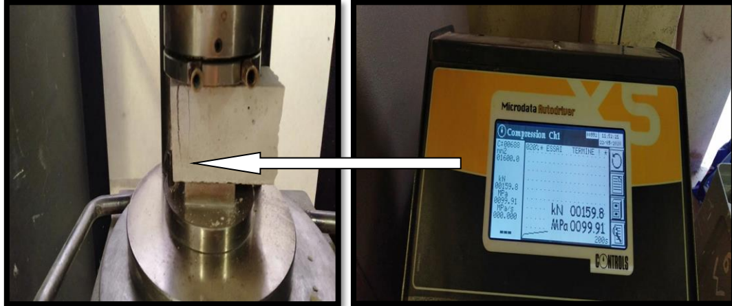
Figure V.7 : Epreuve mise en place sur la presse hydraulique pour déterminer la résistance en compression.
