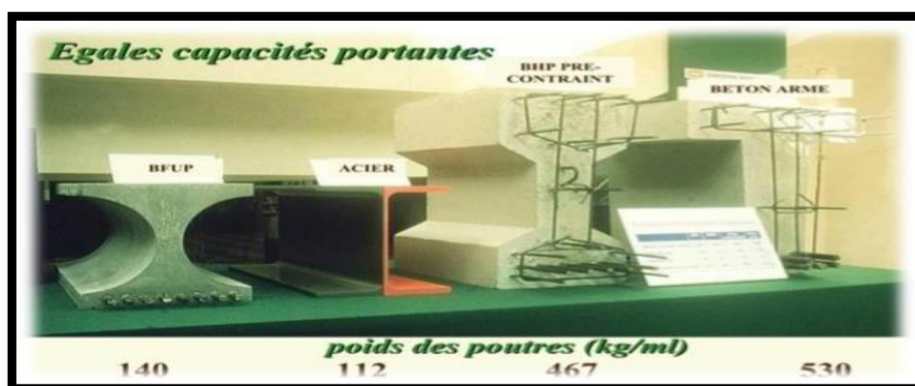
Figure I.4 : comparaison entre la section de BPR et autre béton [Lafarge, 2013].
