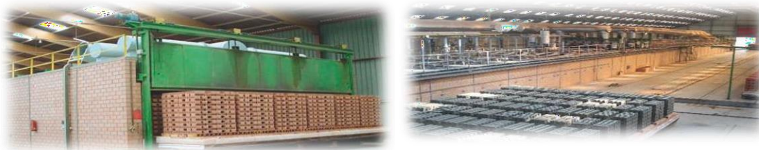
Figure III.5 : le Séchage et le Cuisson de brique rouge . [Marc Mélon ,2017].
