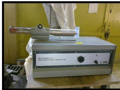
Figure IV.3 : les matériels de l'essai d'équivalent de sable
