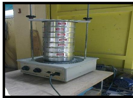
**Figure IV.4 : La tamiseuse utilisée.**
