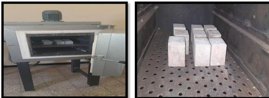
**Figure V.1 : disposition des éprouvettes dans le four**
