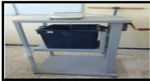
Figure IV.16 : dispositif de la mesure de porosité du béton.
