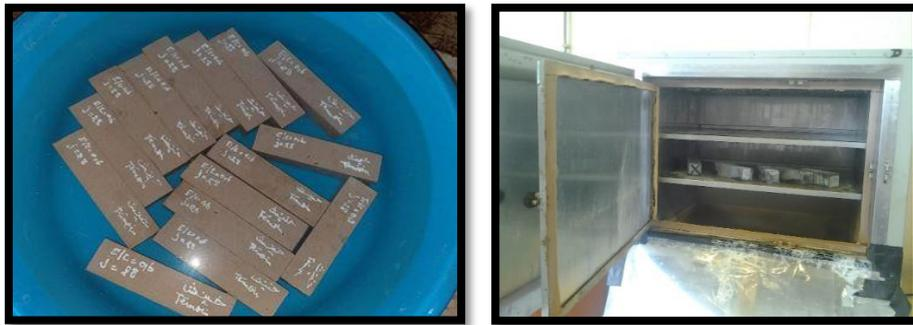
Figure IV.14 : bac de conservation et armoire humide.
