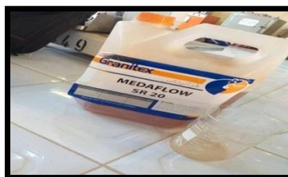
**Figure IV.10 : Super plastifiant utilisée**
