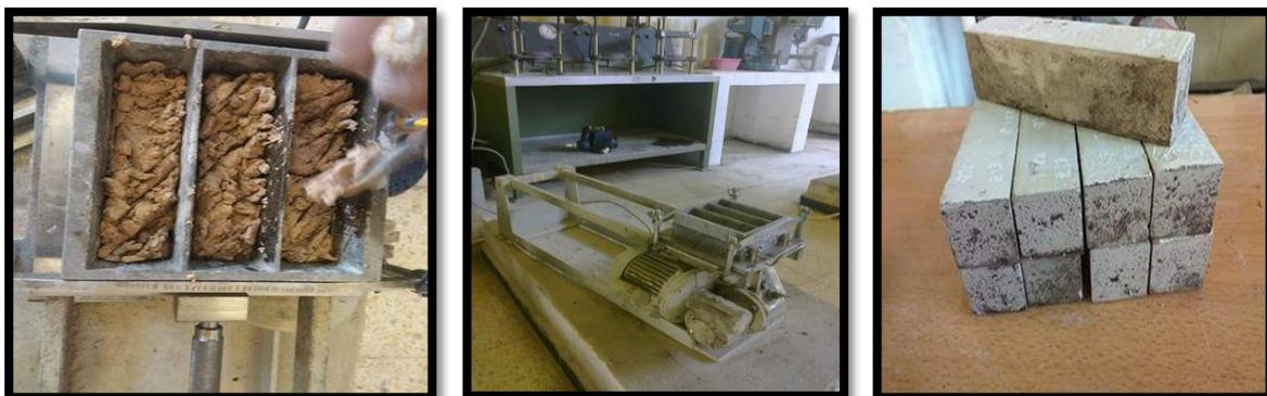
**Figure IV.13 : appareil à chocs, moules et épreuves utilisés pendant les essais.**
