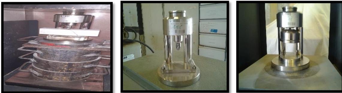
Figure IV.19 : machine d'essais à la pression avec dispositif de compression et de traction.
