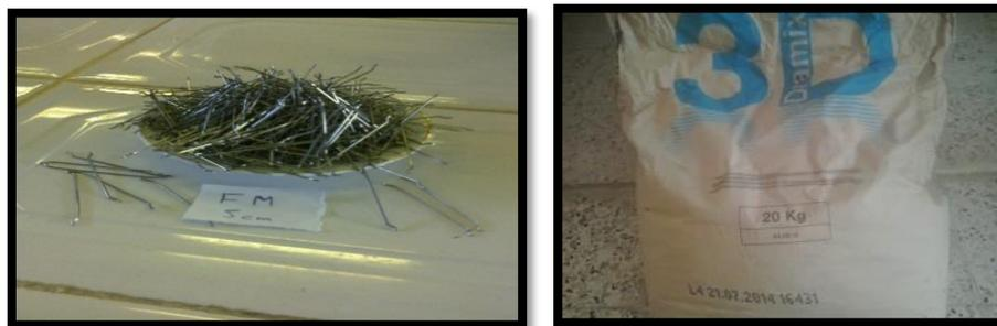
**Figure IV.9 : fibres métalliques «SIKA METAL FIBRES RL-45/50-BN».**
