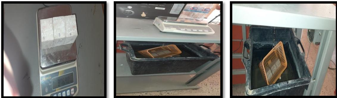
**Figure V.6 : des étapes d'essai de porosité.**
