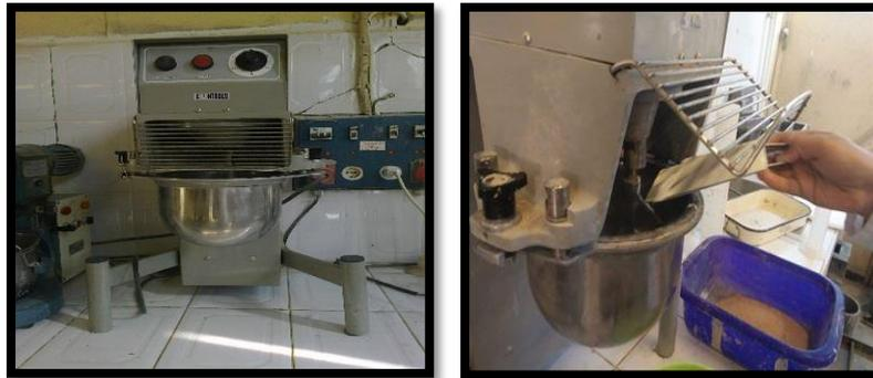
**Figure IV.12 : malaxeur normalisé pour pâte et mortier.**
