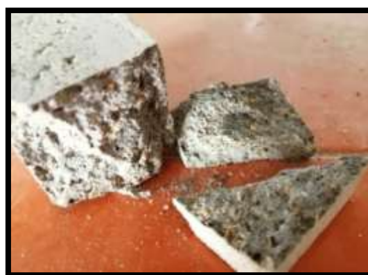
Figure. 6. 9 : Vue macroscopique des facies de rupture du mortier chargé.
