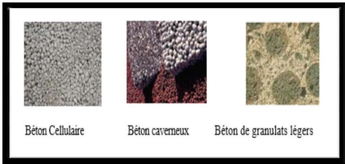
Figure 1 .1: Vue macroscopique des différents types de bétons légers.[2]
