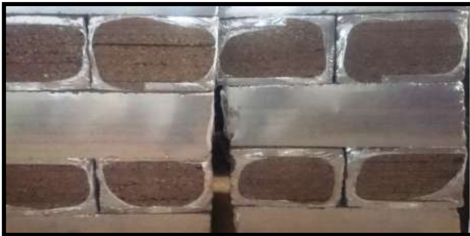
Figure 2.14 : Stockage des plaques du liège expansé.[19]
