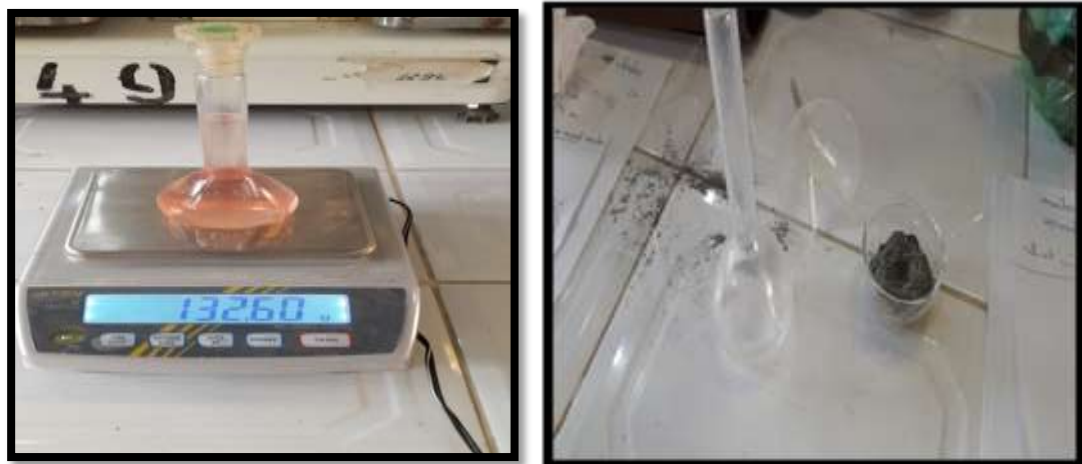
Figure 5. 6. : Exemple de mesure de la masse volumique absolue du ciment.
