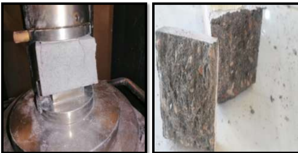
Figure. 6. 8. : Vue macroscopique des facies de rupture du mortier témoin.
